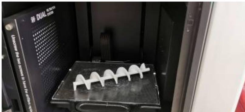
\* Impression 3D d'une vis san fin pour la distribution de grain du poulailler automatisé
