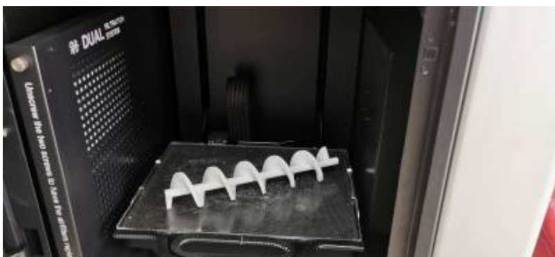
* Impression 3D d'une vis san fin pour la distribution de grain du poulailler automatisé
