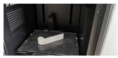
\* Impression 3D de penture de porte pour le projet du poulailler automatisé
