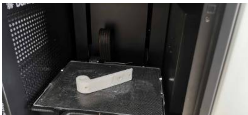
* Impression 3D de penture de porte pour le projet du poulailler automatisé
