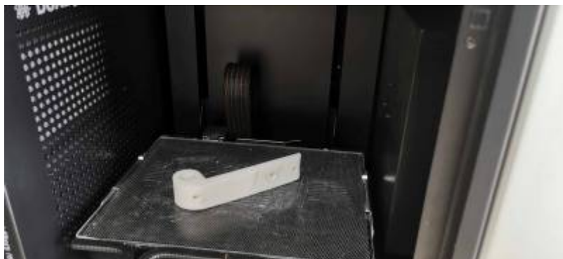
* Impression 3D de penture de porte pour le projet du poulailler automatisé
