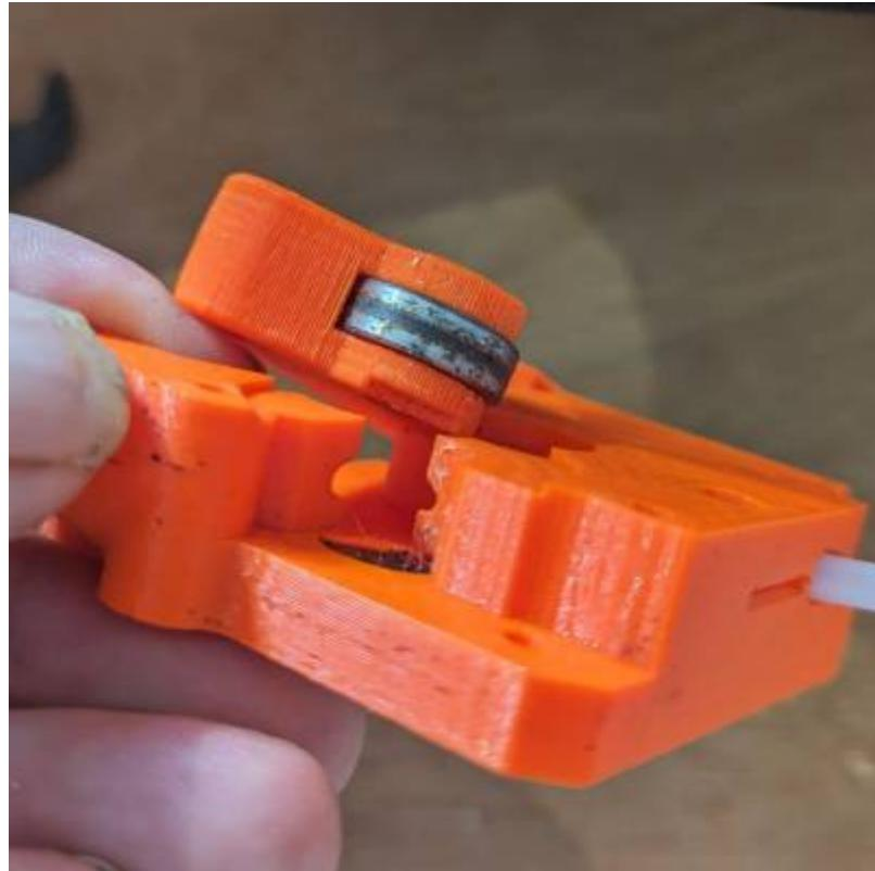
1. Bien soulever (délicatement) et nettoyer (soigneusement) avec une brosse à dents sous la partie mobile au niveau de la poulie ;
