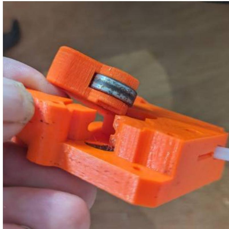
2. Ne pas trop (re)serrer les vis, sinon le filament aura du mal à être entraîné.
