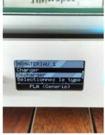
4. une fois le filament déchagé par l'imprimante, le retirer du support de bobine
