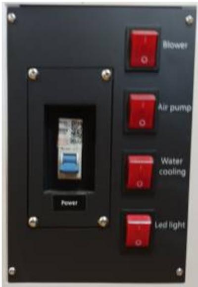
Le laser, l'extracteur d'air (**blower**) et la pompe à air (**air pump**) ne sont pas nécessaires avant le moment de la découpe (voir [la checklist de découpe](#) )
