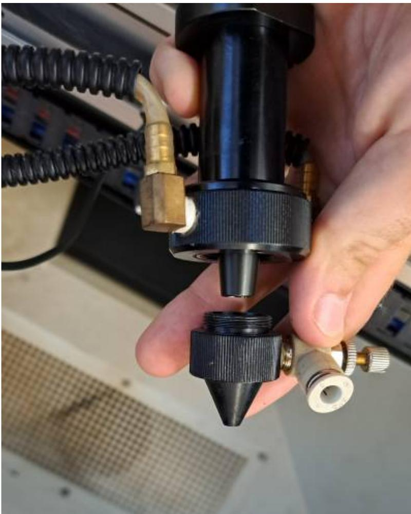
4) Placer la tête à l'envers (la sortie vers le haut) et dévissez le deuxième cône qui protège la lentille des remontées de fumée et poussière. Attention, c'est ce cône qui maintient la lentille dans son logement !
