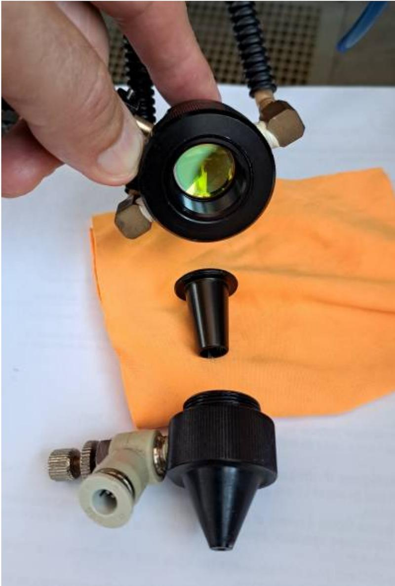
5) Faire tomber la lentille délicatement sur un chiffon microfibre. Le revêtement sur la lentille est très fragile, elle ne doit pas être touchée avec les doigts. Nettoyer la lentille à l'alcool, l'essuyer avec le chiffon microfibre.
