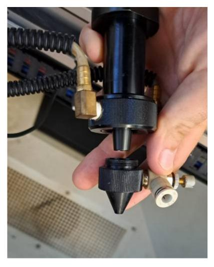
4) Placer la tête à l'envers (la sortie vers le haut) et dévissez le deuxième cône qui protège la lentille des remontée de fumée et poussière. Attention, c'est ce cône qui maintien la lentille dans son logement!
