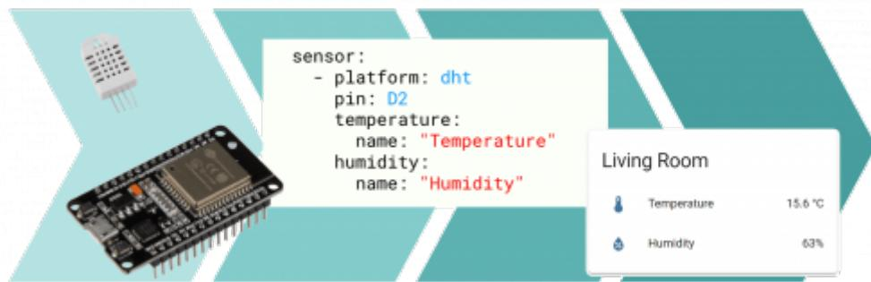
Ce nœud basique est constitué d'un capteur multi-mesure physiquement relié à un micro-contrôleur [ESP](#), connecté en WiFi à un serveur [Home-Assistant](#)
