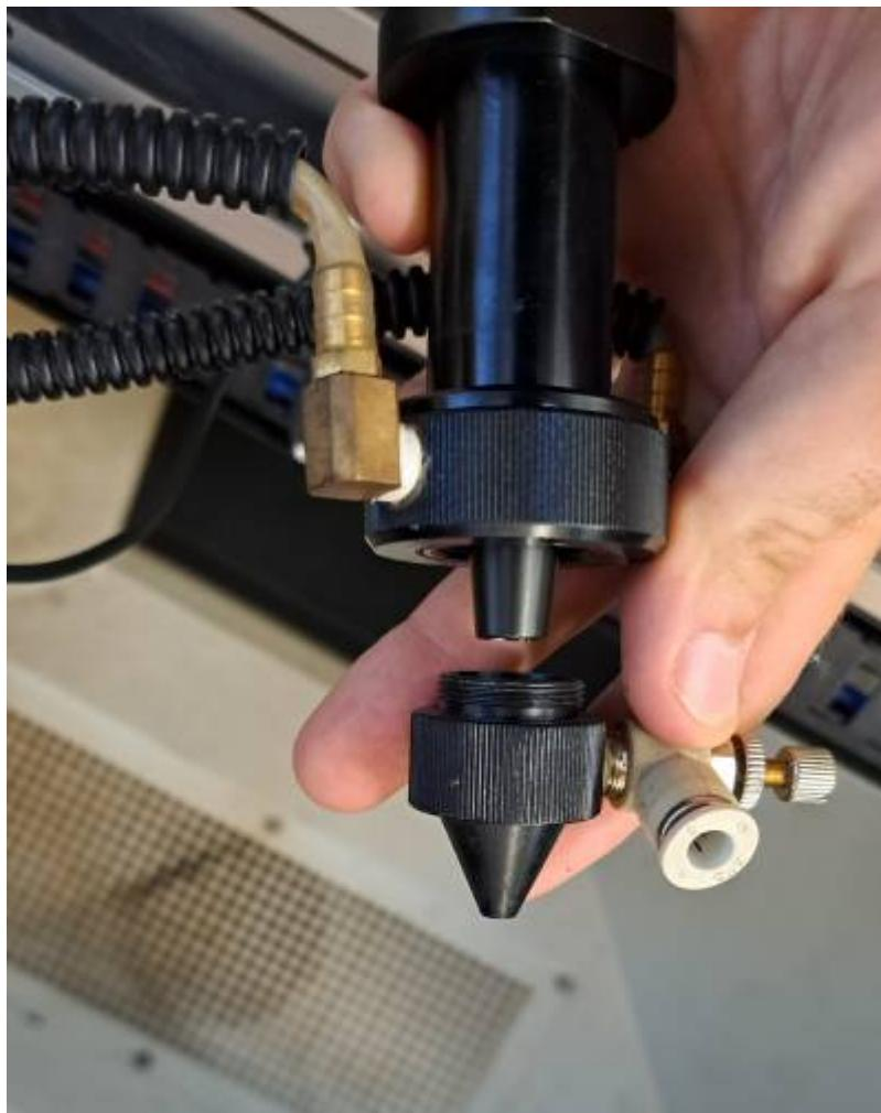
4) Placer la tête à l'envers (la sortie vers le haut) et dévissez le deuxième cône qui protège la lentille des remontée de fumée et poussière. Attention, c'est ce cône qui maintien la lentille dans son logement !
