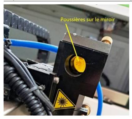
Pour cela vous aurez besoin, d'alcool isopropylique (ou à défaut d'éthanol), de coton tige et d'un chiffon microfibre (type nettoyage de lunette et optique).
