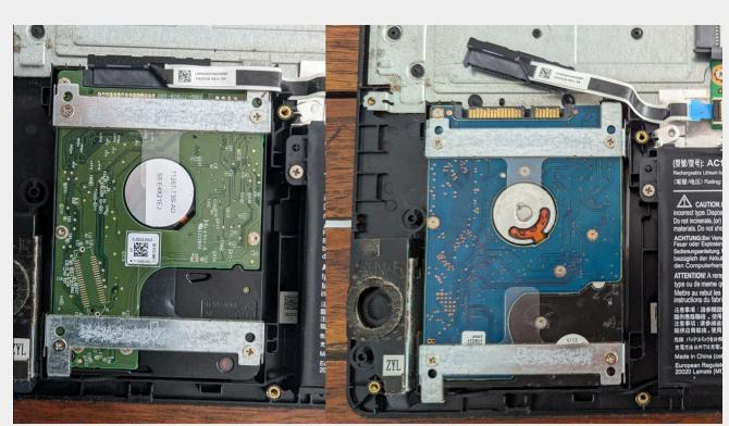
Le nouveau disque dur est vissé sur le rack, le rack est remis à son emplacement, il ne reste que à brancher la nappe puis refermer la coque ...
